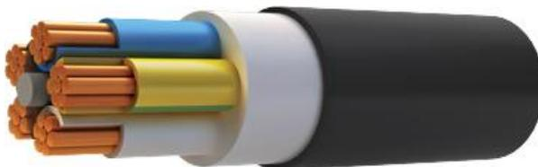
Провода и шнуры для электрических установок на номинальное напряжение до 450 В, с количеством медных жил от 1 до 5, номинальным сечением от 0,5 мм<sup>2</sup> до 10 мм<sup>2</sup>, в поливинилхлоридной изоляции и оболочке, марок:
